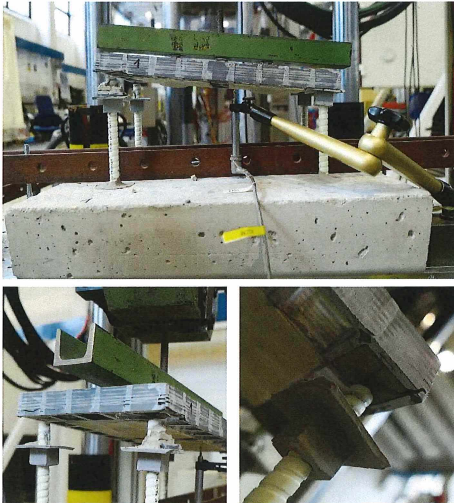
Bild 9: Schadensbild Solar Base Probe 1, Versuch 3
